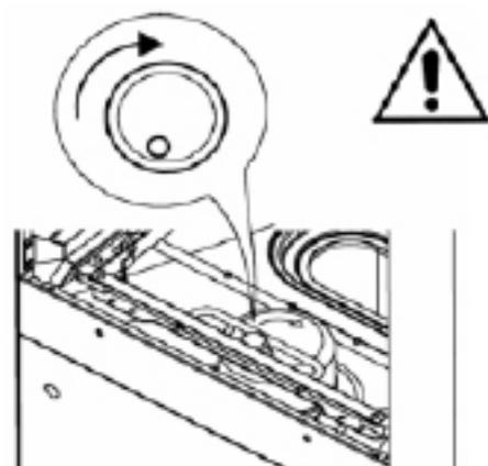
Prüfen Sie, ob die Drehrichtung mit der Abbildung und den Markierungen auf dem zentralen Zugwerk übereinstimmt.
