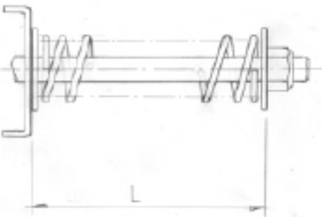
Überprüfen Sie die Einstellung des mechanischen Zugsicherungssystems, das auf die Gesamtlänge der Maschine und die einzelnen Leistungstische abgestimmt sein muss.
